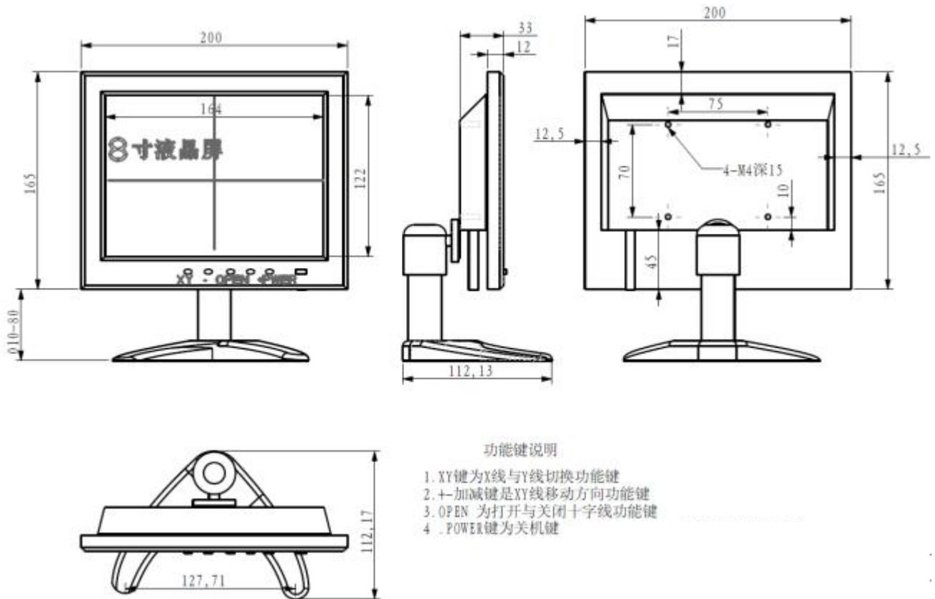
图 1.2.2 监视器安装尺寸示意图
