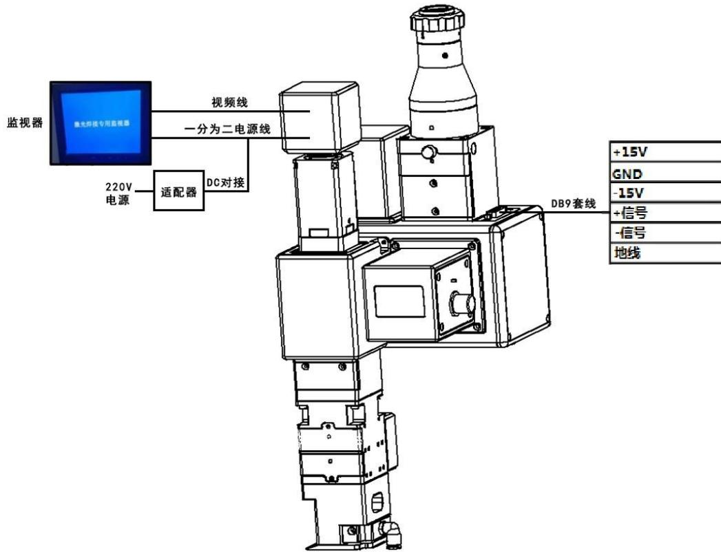
图 2.1 焊接头接线示意图
