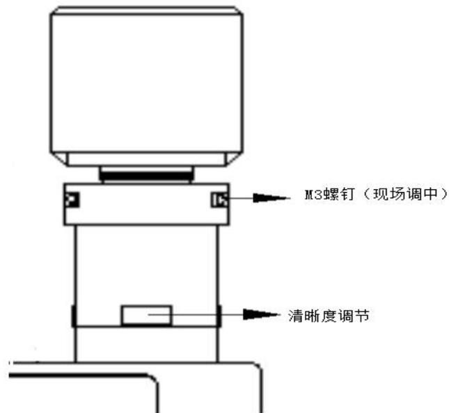
图 3.3 CCD 镜头调节方式示意图
