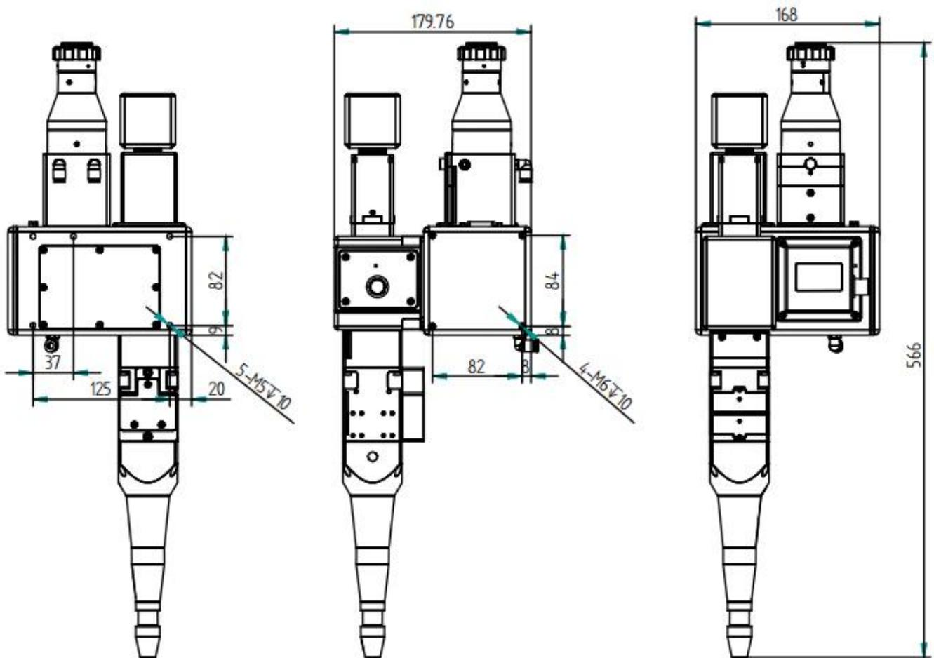
图 1.21 焊接头安装尺寸图
