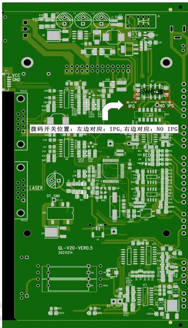
图 2.13 拨码开关示意图
