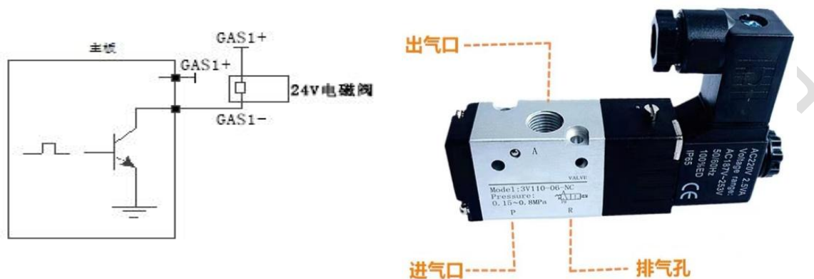
图 2.111 气体控制接口示意图
