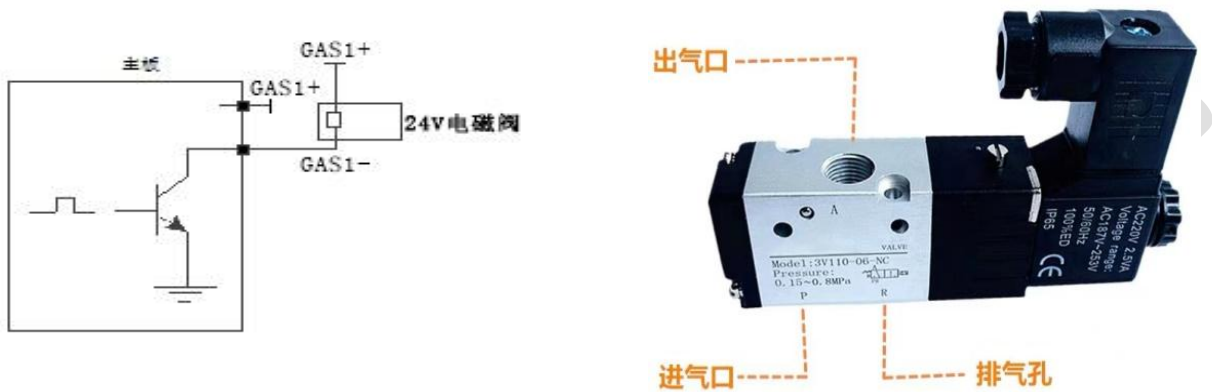
图 2.111 气体控制接口示意图
