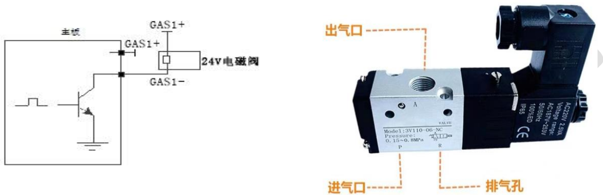
图 2.111 气体控制接口示意图
