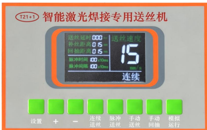
图 2.8 送丝机面板示意图
